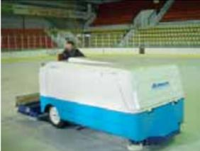
Nová rolba Okay 3000 je stroj nové generace od firmy Dupon s motorem Volkswagen poháněným plynem. Má katalyzátor, olejové náplně jsou z ekologického materiálu a má přídavné zařízení, které ořezává led od mantinelů a zároveň zametá zbytky a odsává přebytečnou vodu.
