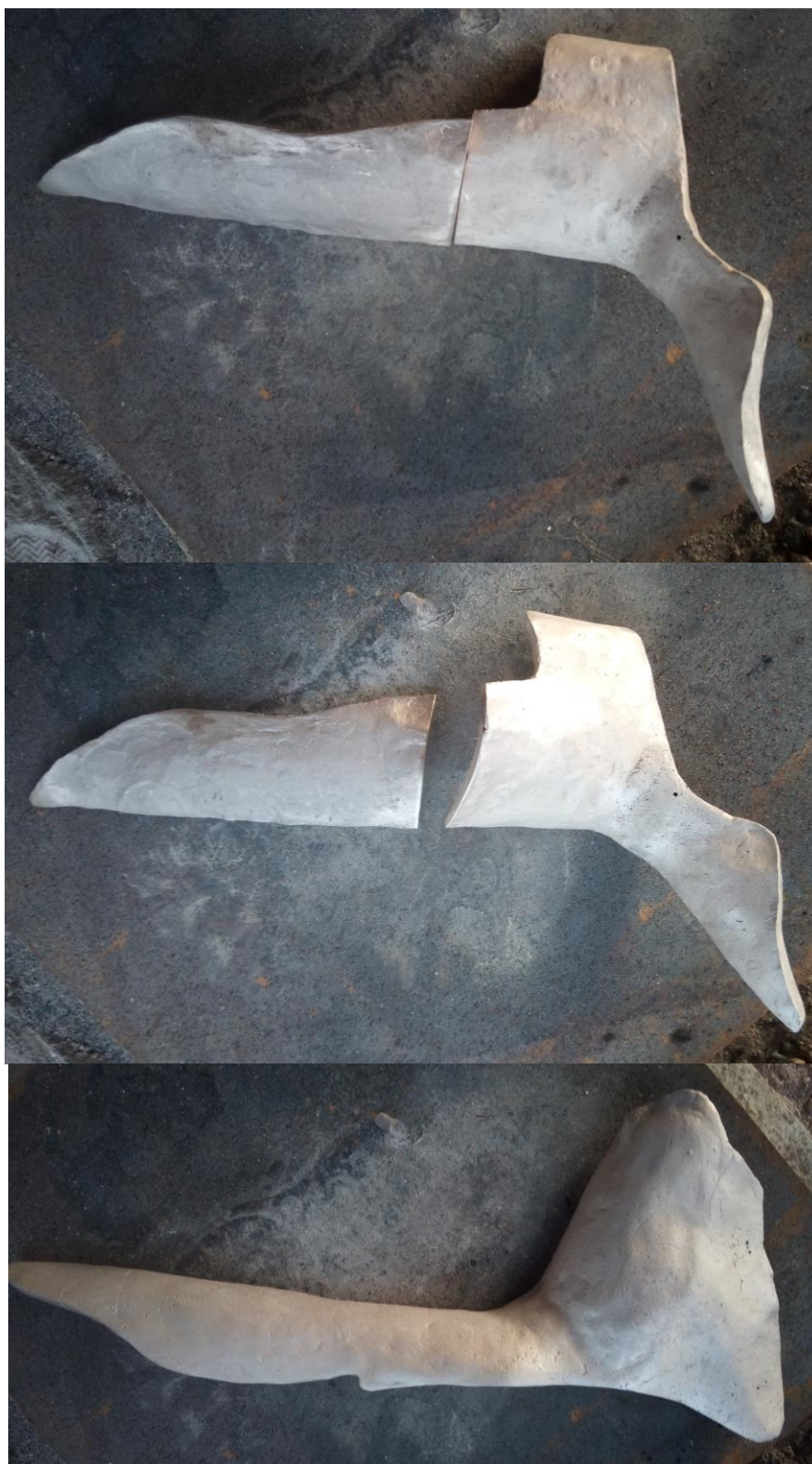
Ostatní odlitky po opracování a připravený k osazení na sochu
