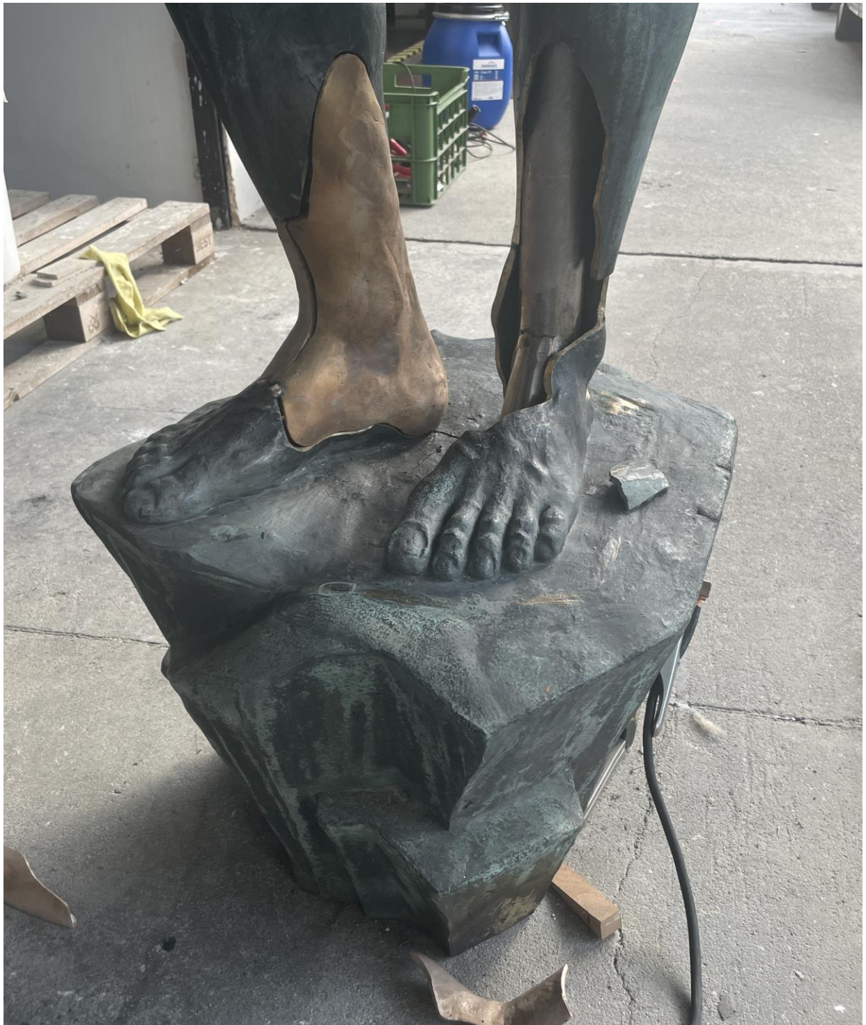
Průběh osazování – svařování odlitků k soše
