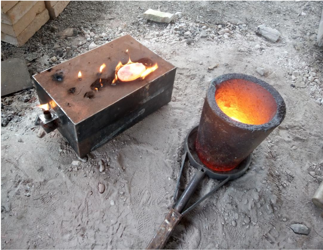
Tavící nádoba a zalitá forma
