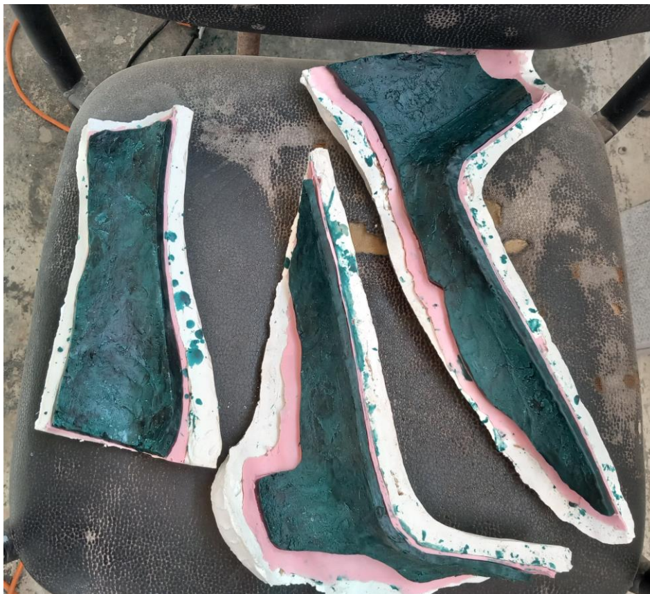
Provedení vytření forem střepek licího vosku=model pro vlastní odlitek
