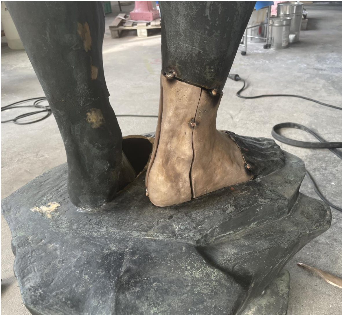
Průběh osazování – svařování odlitků k soše
